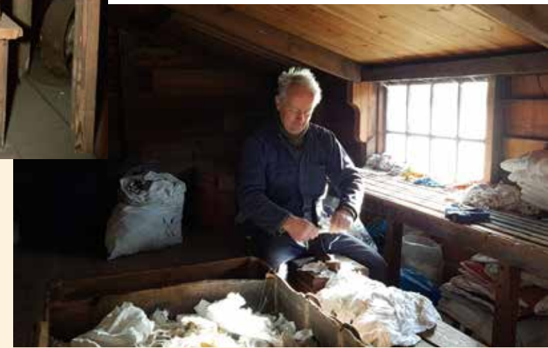
1972 en 2020 Het scheuren van de vodden die een belangrijke grondstof zijn voor het maken van papier. In het scheurhok worden de vodden eerst op kleur en materiaal gesorteerd, ontdaan van knopen en daarna in kleine stukjes gescheurd. Op deze foto's is de scheurbank goed te zien, met het mes om een inkeping in de vodden te maken als beginnetje van het scheuren.
