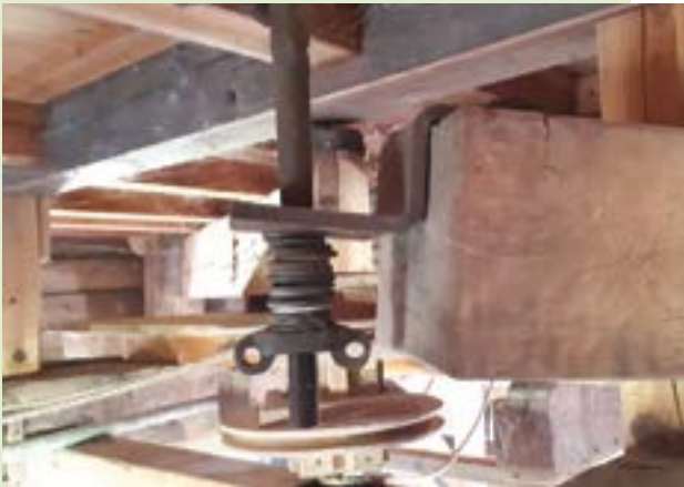
De pasbalk met stelringen en de vleugelmoer
