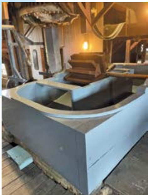
De roerbak na schaven, schuren en schilderen
