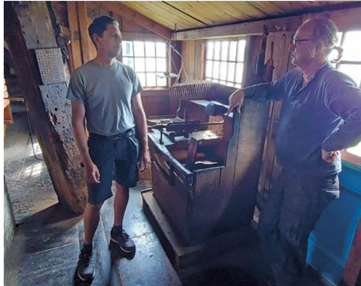
Dit is het koekenhok, hier haal je de buul leeg van de droge koek, de olie is eruit geslagen
